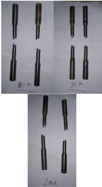
Gambar 1. Spesimen 80,90,100 A (1 dan 2) setelah di uji tarik
